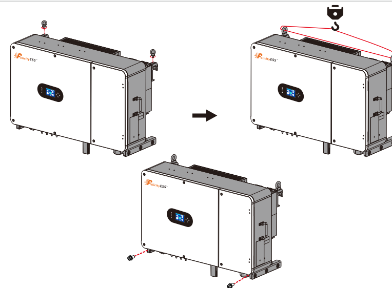
Figura 3.4-2 Instalarea unui invertor
